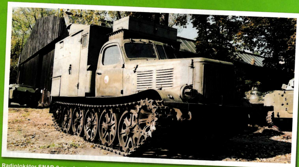
Radiolokátor SNAR-2 na pásovém podvozku dělostřeleckého tahače AT-2
